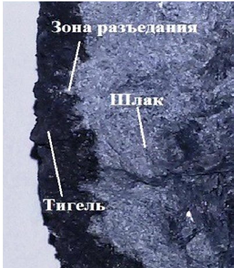
На рисунке показана зона взаимодействия периклазографитового тигля шлаком № 7 на основе диопсида.
