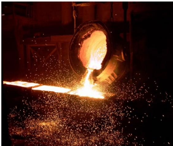
В агрегате печь-ковш металлургические процессы протекают в восстановительных условиях, при основности шлака, близкой к 3, поэтому футеровку агрегата печь-ковш выполняют из периклазо-графитовых огнеупоров.
